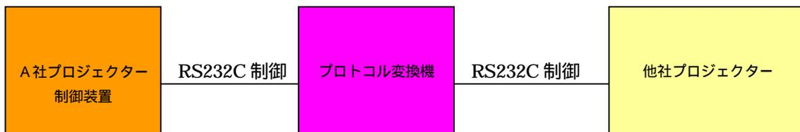
A社プロジェクター制御装置はそのままプロトコル変換機に接続する、A社プロジェクター制御装置からの制御コマンドを変換し他社のプロジェクターを制御する。
